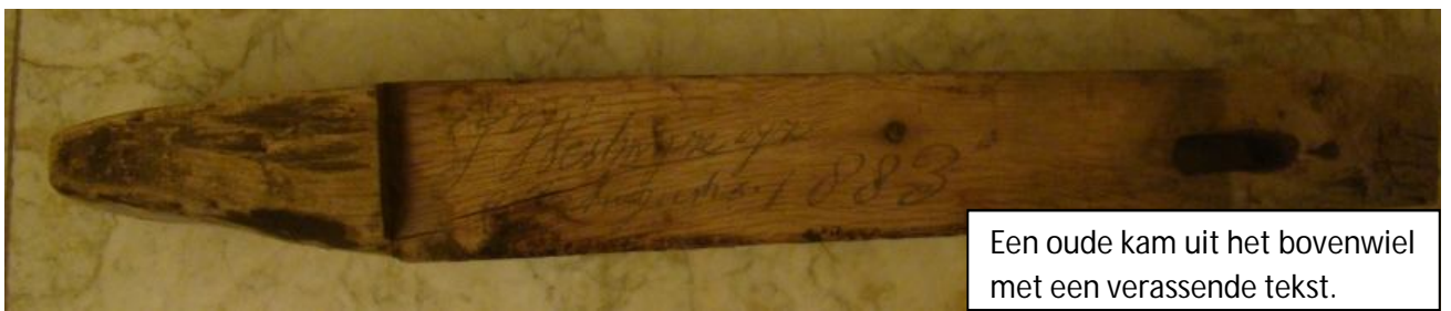
Het herstel van het bovenwiel. Alle kammen zijn vernieuwd.
